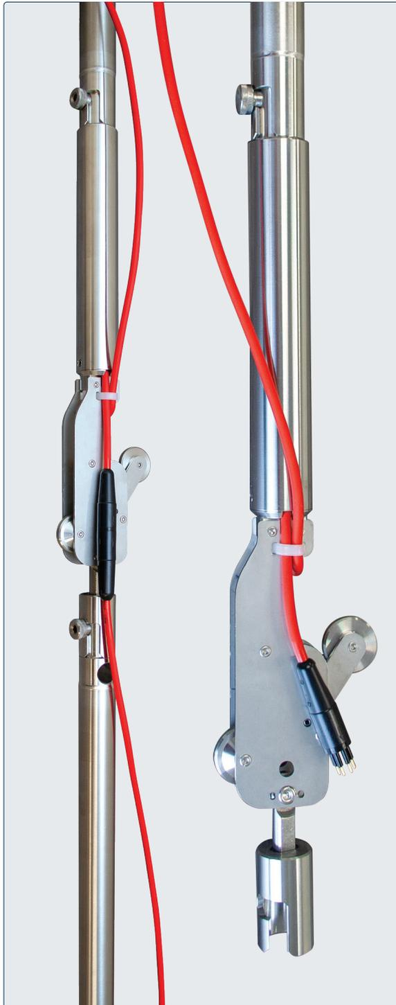
Detalhe apresentando o cabo de sinal que se conecta a cada sensor por todo o conjunto de sensores de inclinômetro, formando um "barramento digital".
