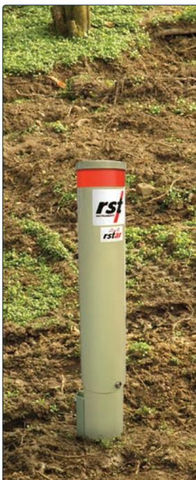
El Sistema de monitoreo de pendiente GAA2820 está protegido por un gabinete secundario de 8" que puede ser pedido de manera separada. El gabinete utiliza una llave de tuerca de 11 mm para asegurar la cubierta removible.
