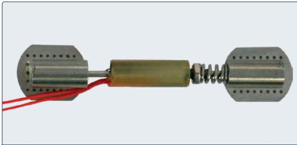
Deformímetro de cuerda vibrante soldable por punto – bajo perfil
