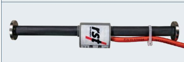
Deformímetro de cuerda vibrante de incorporación
