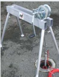
Se puede comprar el sistema de suspensión robusto para brocal de pozo opcional para reducir tremendamente el esfuerzo requerido para bajar y levantar los obturadores de pozo dentro de los pozos y aplicaciones similares. Visitar [rstinstruments.com](http://rstinstruments.com) o ponerse en contacto con RST para información adicional.
