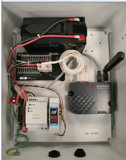
Registrador de Dados CR300 FlexDAQ exibidos com modem celular opcional para comunicação de dados.
