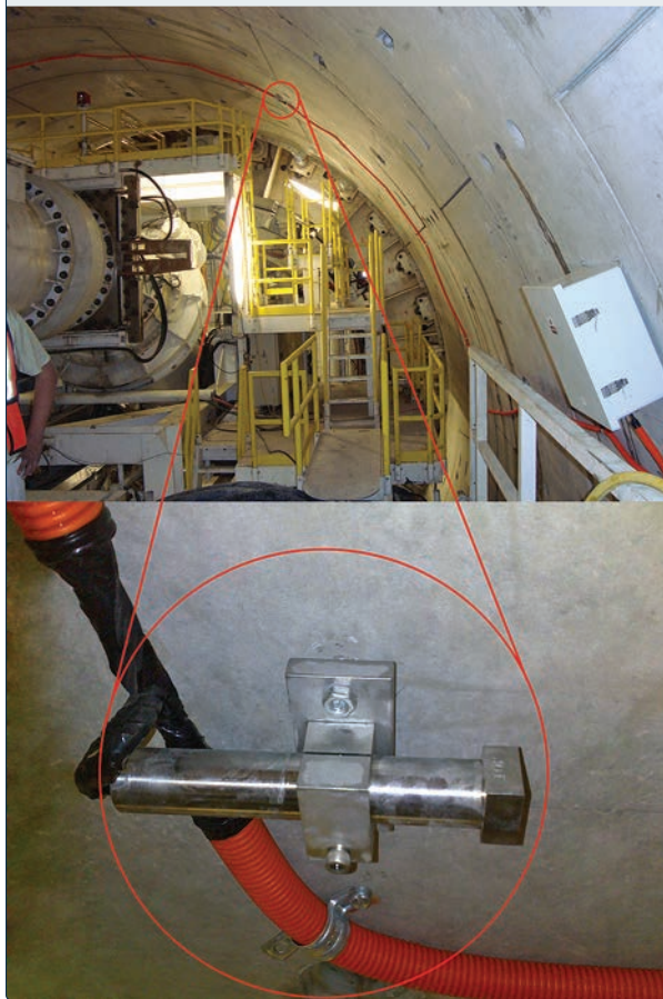
Instalación típica ilustrada abajo del sistema de monitoreo de perfil para segmentos de hormigón de túnel de RST con un sistema de registro de datos FlexDAQ.
