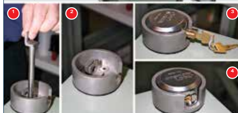
Gabinete del adquirente con pedestal con vista de cerca del procedimiento para activar el mecanismo de cierre resistente al vandalismo.
