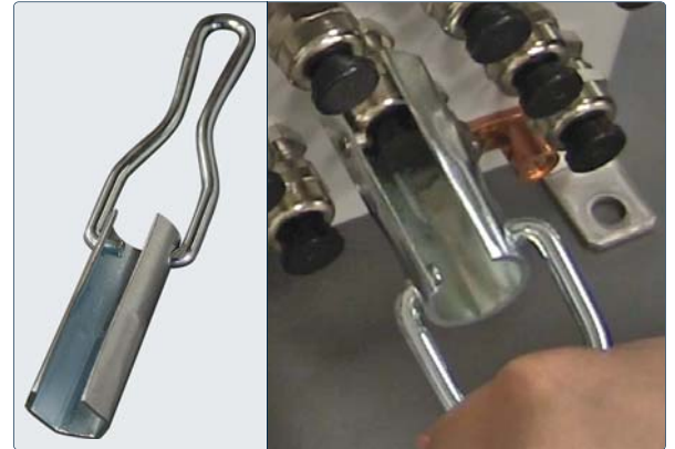
La llave de nuez de glándula de cable (DT100) mejora el acceso a las glándulas en comparación a una llave estándar.
