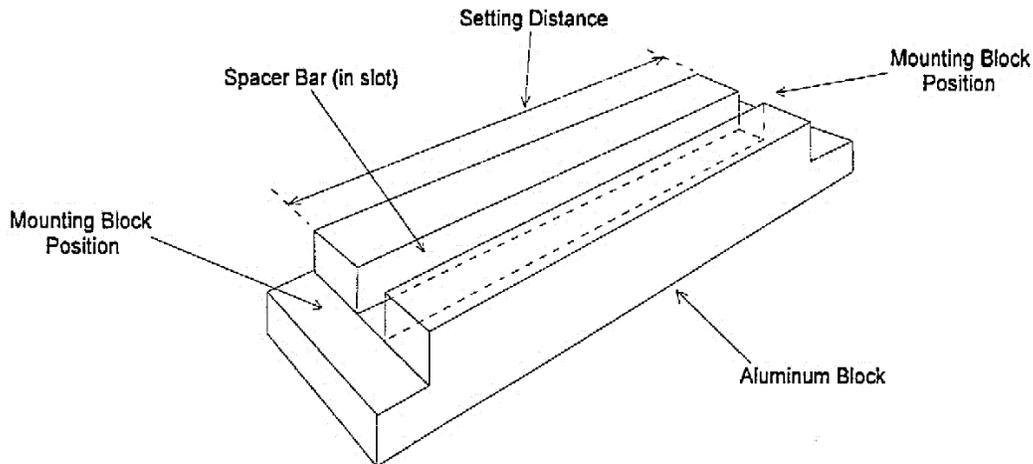
**FIGURE 3-1      SPACING JIG**
